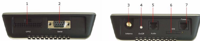
Figura 2 – Dettaglio delle connessioni della centralina Drin Passepartout
