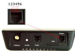
Figura 3 – Configurazione dei contatti elettrici del connettore di alimentazione RJ6 della centralina.
