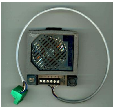
Figura 12 - Dettaglio del collegamento del gruppo fonico Elvox 930.
